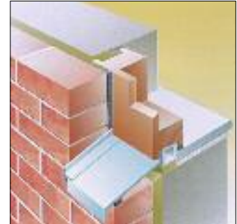
Abdichtungen im Fensterbereich
